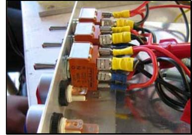
Figure 31: [Crimp-On Terminals](#)
